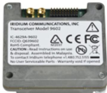
火柴盒大小的“铱 9602”比第一代“铱 9601”SBD 调制解调器缩小了 69%，重量减轻了 74%，成本也更加低廉。“铱 9602”的另一独特性能是内置了 GPS 输入/输出端口，可使系统集成器与外置 GPS 接收器连接，GPS 和铱 SBD 使用同一个双模 L 波段天线，节省了一个天线的成本。
