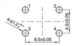
请使用1.6mm厚的印刷电路板
