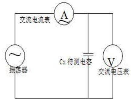
图 3. 交流阻抗测试电路图
