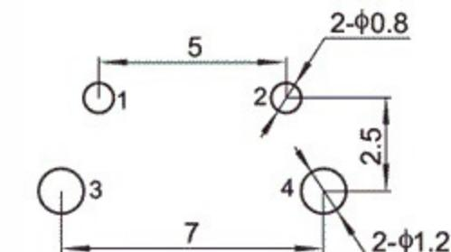
请使用1.6mm厚的印刷电路板
