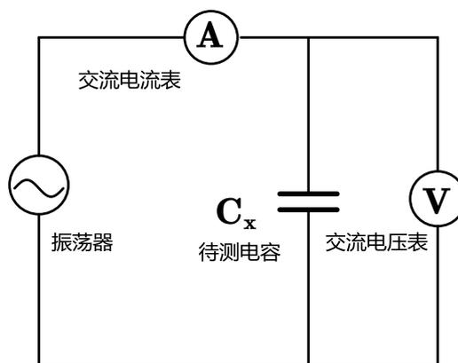
图 3. 交流阻抗测试电路图
