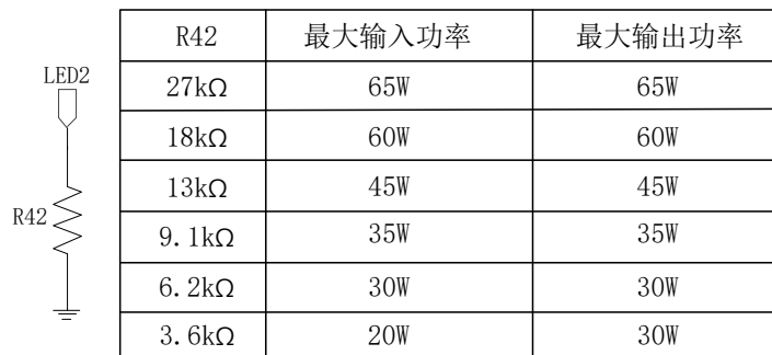
图 15 功率配置连接电路
