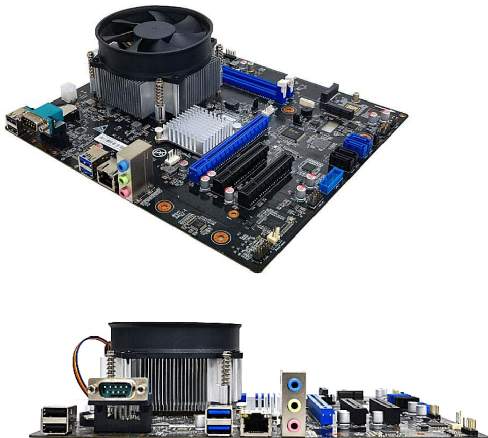
GM9-3001是一款采用龙芯3A5000+7A1000 芯片组的MATX主板，可搭配主流台式机/一体机机箱。支持集成显卡和PCIe独立显卡。
