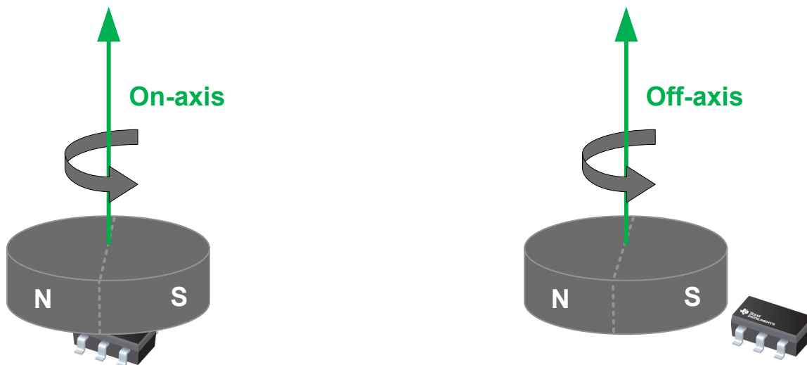
图 8-16. 同轴角度测量与离轴角度测量
