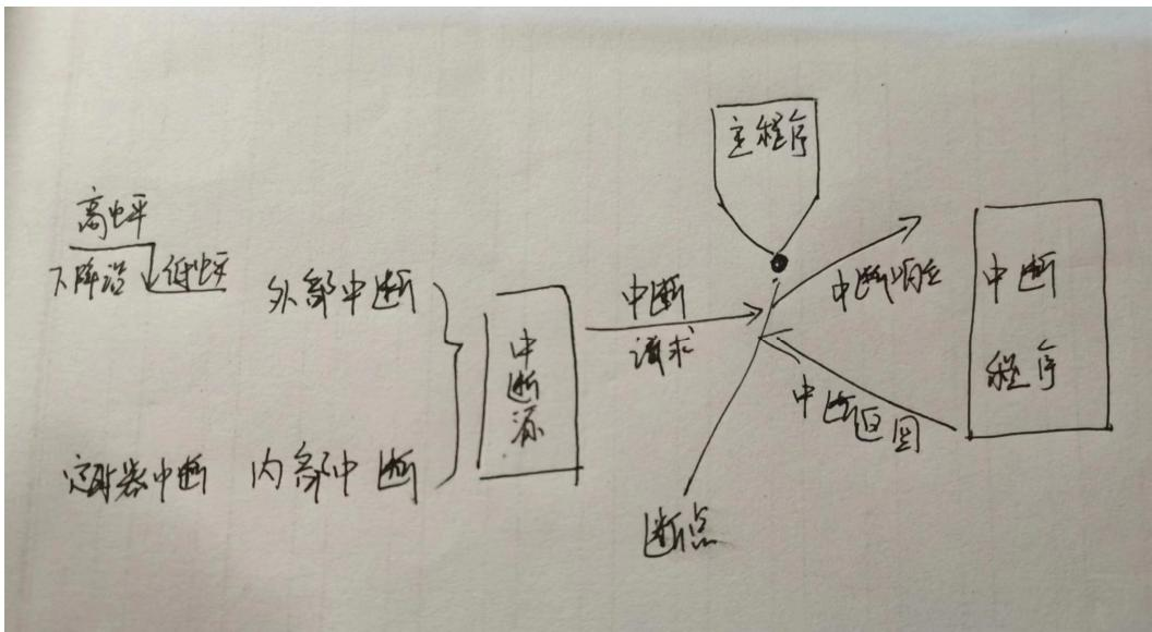
中断源向CPU提出中断请求，CPU暂时中断原来正在处理的事件A，转去处理事件B，处理完毕后再返回原来被中断的地方。
