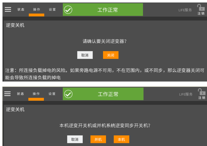
图 4-14 单机、并机逆变关机命令
