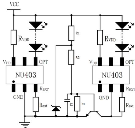
說明：DC power 調光應用 ( PWM ) 中雙色溫調節。其原理是通過上圖中的 C、R2、R3 實現的，通過改變容量大小可以改變延時比例。
