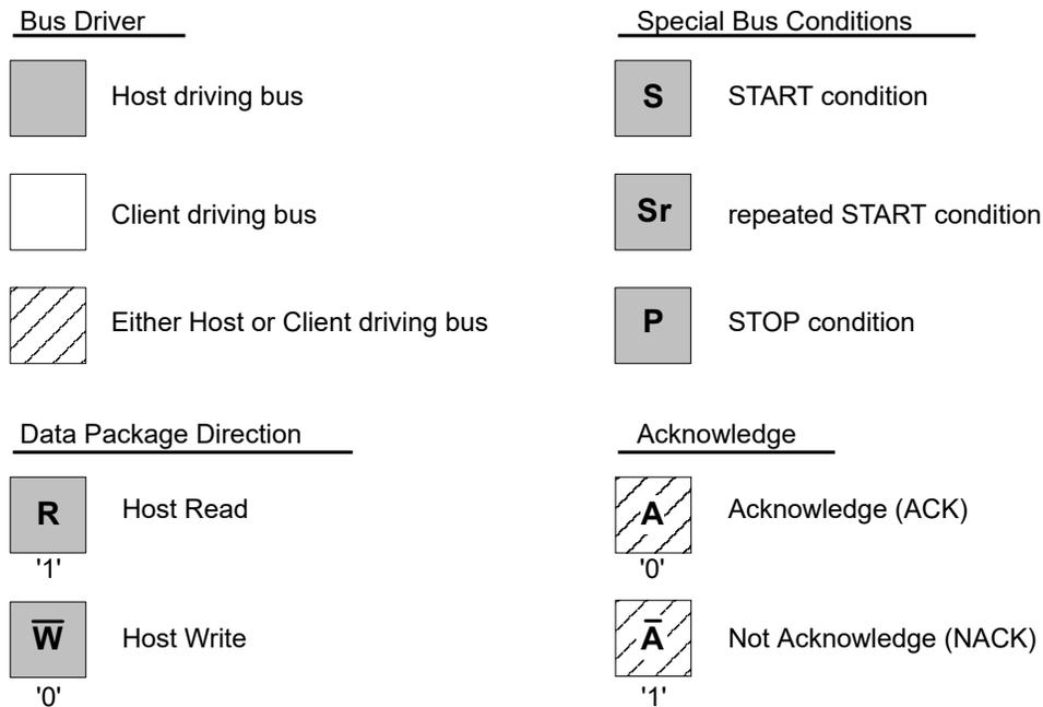
**Figure 33-3. Basic I<sup>2</sup>C Transaction Diagram**
