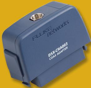
对于任何同轴电缆，安装的成功依赖于使用高品质的元件和正确的安装方法，尤其是连接器的安装。配合 DSX-5000 CableAnalyzer 使用时，DSX-CHA003 同轴电缆适配器让您能够确定安装的同轴电缆的传输性能，以确保其在目标应用中符合预期性能。DSX-CHA003 同轴电缆适配器支持对 50 ohm、75 ohm 和 93 ohm 同轴电缆进行测试。
