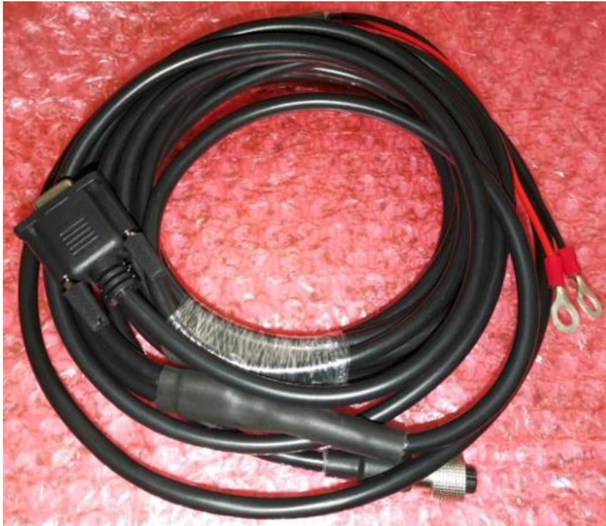
线的左边为 6P 航空插头母头,右边为一红一黑的电源接头和 RS232 串口母头。
