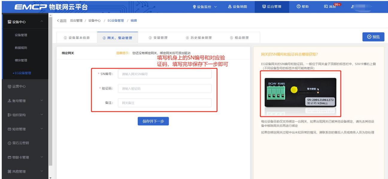
此时在右侧“网关概况”中可以看到绑定的控制器是否连接到平台（成功登录平台可以看到“在线”绿色字样，如果不成功则显示“离线”灰色字样，此时请检查网络或检查设备供电）。
