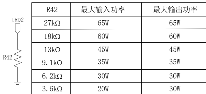
图 15 功率配置连接电路
