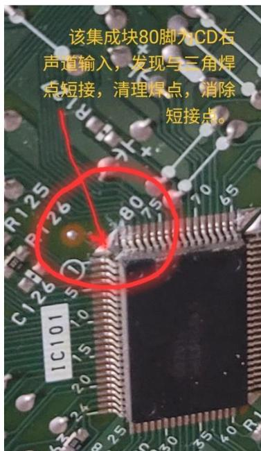
用针清理,消除短接点,通电,单独播放 CD 右声道,用表笔触碰 80 脚,音箱发出噪
