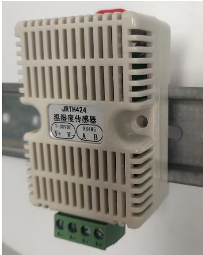
5-2 导轨安装正面示意图
