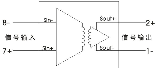
2.信号输入、信号输出对应关系示意图（理想状态）
