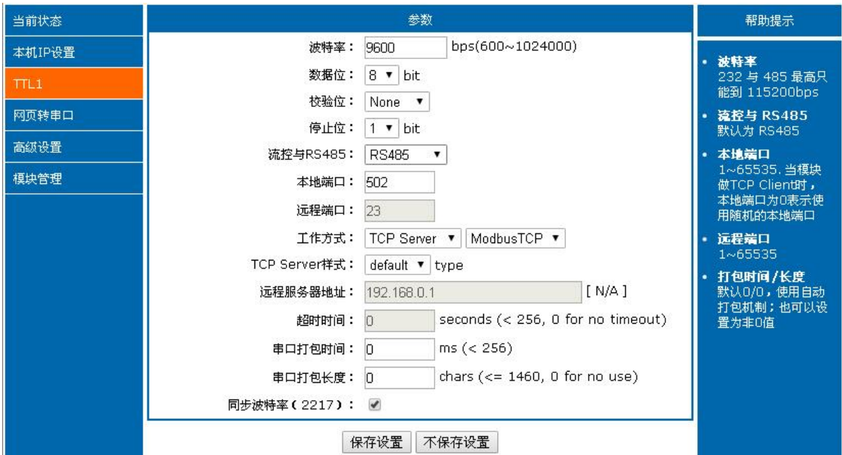
图 4 YL102 设置成 MODBUS TCP 通讯协议后的参数
