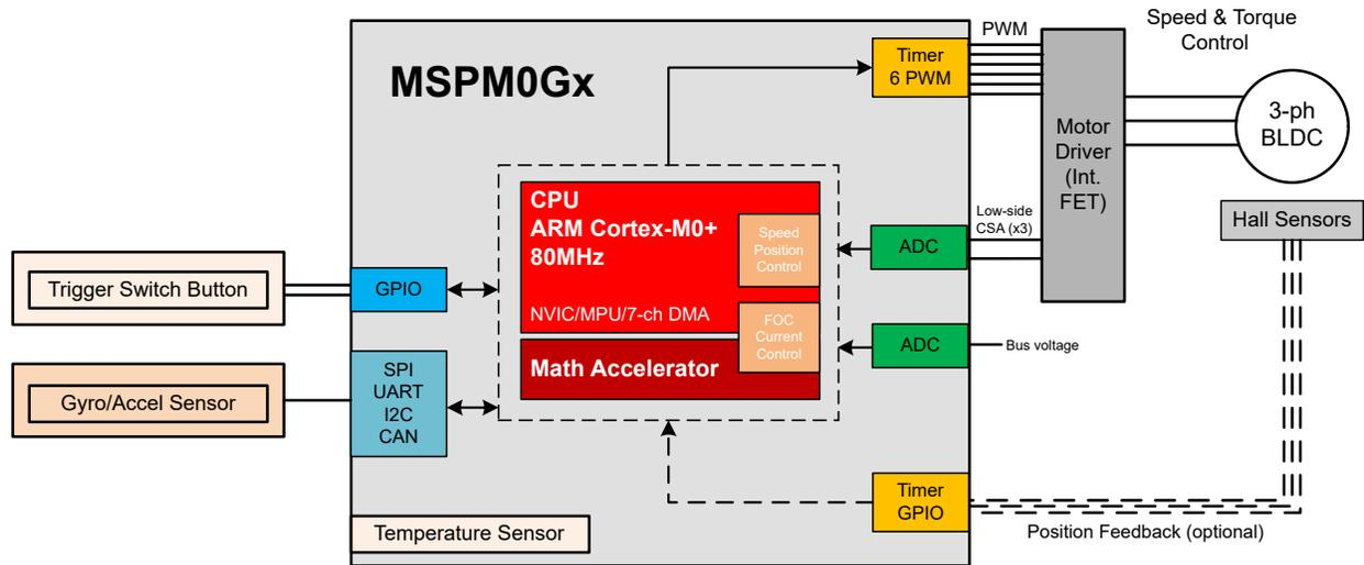
图 3. 基于 MSPM0Gx 的自拍杆系统方框图
