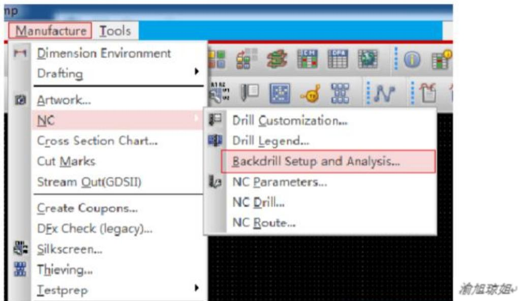
5.设置需要背钻的层，如需要背钻的信号分布在 Layer5、Layer8，背钻从 Botom->Top 方向背钻，将要钻掉的层设置分别设置为 Bottom->Layer6、Bottom->Layer9，设置如下
