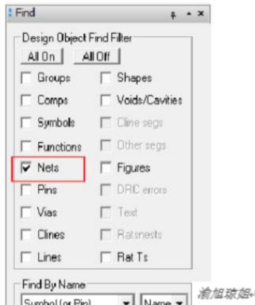
3. 选择要背钻的网络，增加背钻属性，背钻 Stub 值可以填 8，但是工厂加工能力可能达不到，此 Stub 值意义不大，随后点击“Apply”
