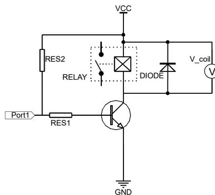
(3)为补偿晶体管的压降，当晶体管供电电源电压为5V时，建议选用4.5V规格继电器，3V时选用2.4V规格继电器；
