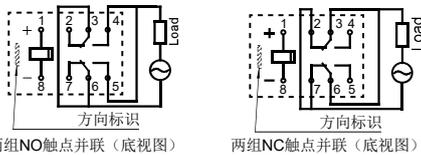
(6)低电平、长耐久性应用场合建议将两组NO或NC并联使用, 若需使用单组NO或NC, 请与我司联系。
