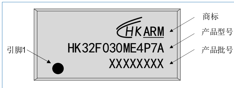
图 7-22 TSSOP24 HK32F030ME4P7A 丝印示例
