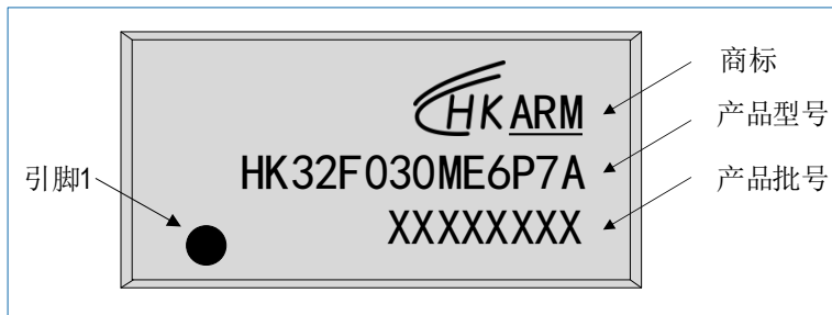
图 7-23 TSSOP24 HK32F030ME6P7A 丝印示例
