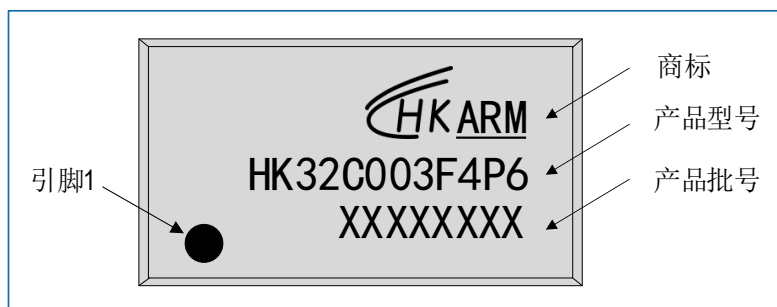
图 7-10 TSSOP20 HK32C003F4P6 丝印示例
