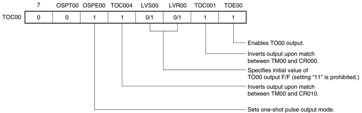
**(d) 16-bit timer mode control register 00 (TMC00)**
