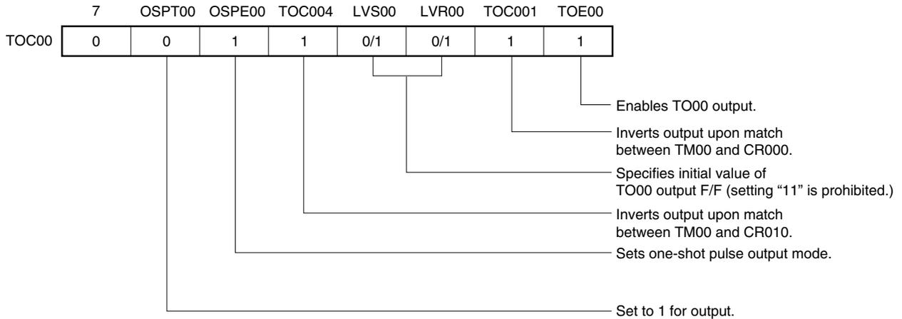
(d) 16-bit timer mode control register 00 (TMC00)
