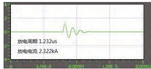
CT47-5868-PD-1500V-404K-Z 规格 (施加 0.9U_R , 负载: R \approx 70m\Omega ESL < 70nH )
