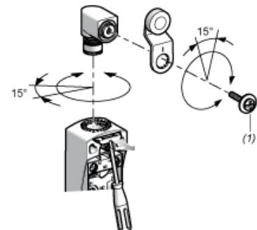
(1) Tightening torque (Min : 1) (Max : 1.5)
