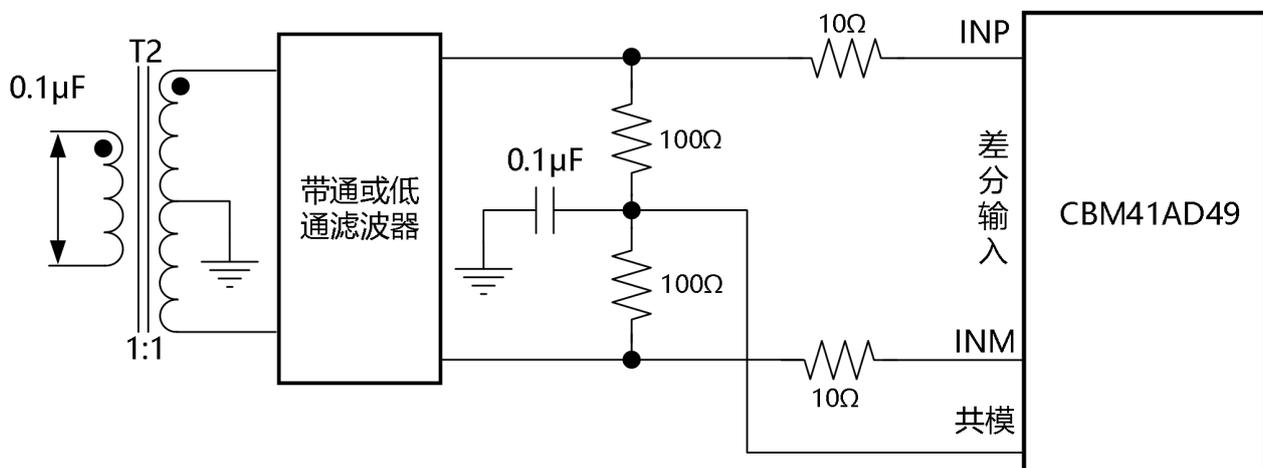
图 2.1 1: 4 的变压器驱动电路
