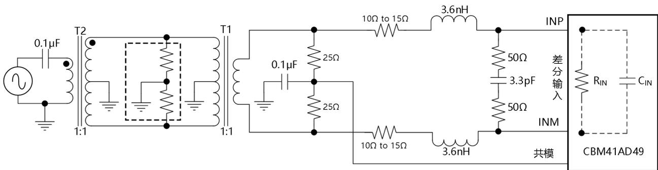
图 2.0 (a) 低频模拟输入驱动电路
