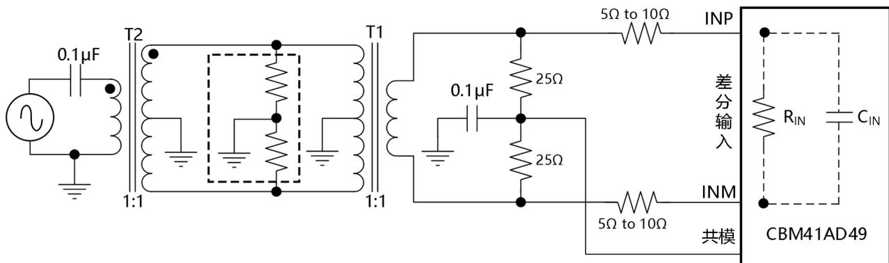
图 2.0 (b) 高频模拟输入驱动电路
