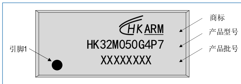
图 7-7 TSSOP28 HK32M050G4P7 丝印示例
