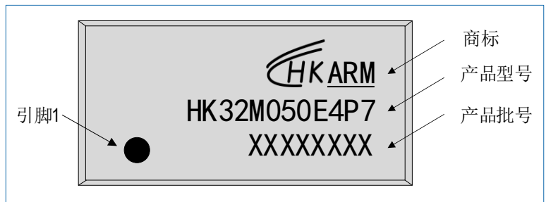
图 7-9 TSSOP24 HK32M050E4P7 丝印示例
