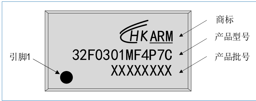
图 7-8 TSSOP20 HK32F0301MF4P7C 丝印示例
